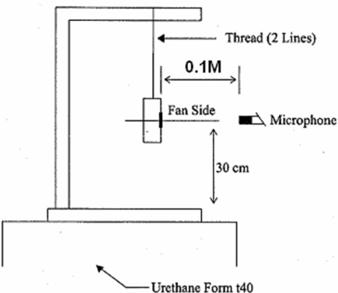
0.1 METER FROM MICROPHONE TO FAN INTAKE
